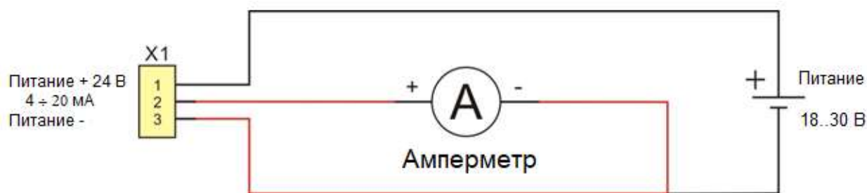
Рис.4. Разъём X1 для, предназначенный для подключения электропитания и вывода токового сигнала
